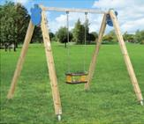
GRGL347<br>ALTALENA 1 POSTO CON SEGGIOLINO A GABBIA<br>Area di sicurezza necessaria cm 750x400 ACL 140cm<br><br>Le altezze di caduta libera (ACL) superiori ai 100cm comportano la necessità di pavimentazione antitrauma a norma UNI EN 1177<br>Altalena conforme alla normativa UNI EN 1176 certificata TUV<br>A seguito di vs comunicazione | NR   | 0    | 1.290,00 €  | 15%    | 0,00 €   | 22  |
